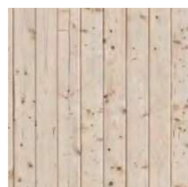
Facade og baldakin Type 1 som restparti / 2. sorterings træ i faldende længder, som lodret brædder
